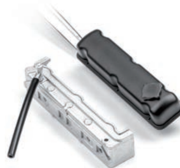
Шаг 6. Установите крышку маслозаливной горловины поверх крышки головки блока цилиндров.
