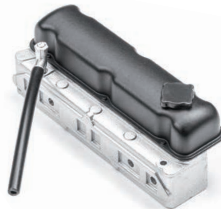
Шаг 7. Поместите крышку головки блока цилиндров на правую половину головки. Закрепите детали двумя винтами 2,0x4 (GM) с внутренней стороны головки блока цилиндров.
